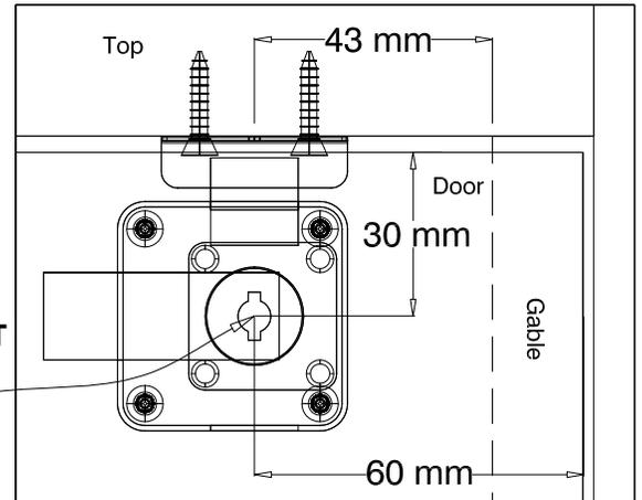
USE  $\varnothing 3/4"$  DRILL BIT FOR LOCK CORE
